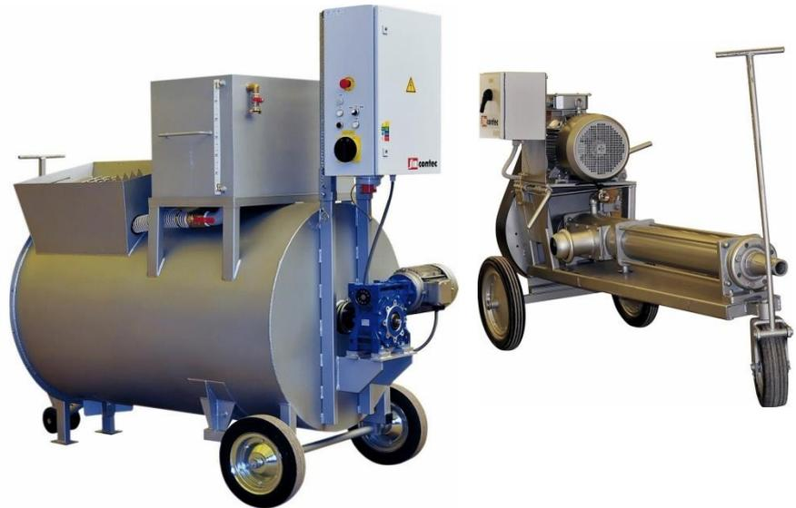
**Einsatz:** Die Anlage ist zur PsB-Herstellung direkt auf der Baustelle oder im Werk bestimmt. Sie ist zur PsB-Herstellung mit der Rohwichte bis zu 800 kg/m<sup>2</sup> im Frischzustand bestimmt. Höhere Rohwichte kann beim reduzierten Volumen der Frischmischung produziert werden. Die Dosierung der Komponenten und Mischzyklussteuerung erfolgen manuell. Der Einsatz des Schneckenförderers zur Bindemitteldosierung ist empfehlenswert.
